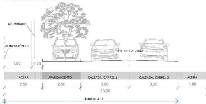
Se ajusta la calzada rodada existente de doble dirección a un ancho de 6,40 m, se introduce una nueva la banda de aparcamiento con un ancho de 2,50 m y se dispone un nuevo acerado con ancho de 2,50 m, de forma que con nueva disposición de puntos de alumbrado permita disponer de un itinerario accesible de 1,80 m libre de obstáculos (art. 11.13 PGOU y artículo 5 Orden TMA/851/2021).
