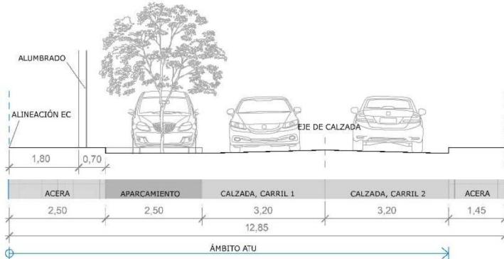
Se ajusta la calzada rodada existente de doble dirección a un ancho de 6,40 m, se modifica la banda de aparcamiento existente para dotarla de un ancho de 2,50 m y se dispone un nuevo acerado con ancho de 2,50 m, de forma que con nueva disposición de puntos de alumbrado permita disponer de un itinerario accesible de 1,80 m libre de obstáculos (art. 11.13 PGOU y artículo 5 Orden TMA/851/2021).
