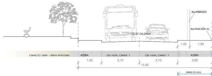
No se actúa sobre la calzada rodada existente que se mantiene, se actúa exclusivamente sobre el acerado existente que amplía su ancho a 2,80 m, de forma que sin la necesidad de modificar los puntos de alumbrado existentes permita disponer de un itinerario accesible de 1,80 m libre de obstáculos (art.
