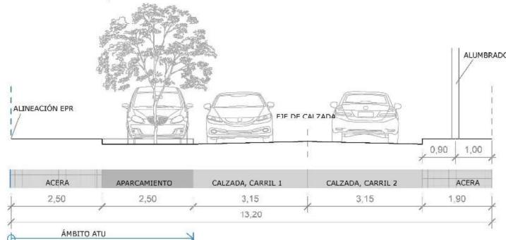
No se actúa sobre la calzada rodada existente que se mantiene, se introduce una nueva banda de aparcamiento con ancho de 2,50 m y se dispone un nuevo acerado a 2,50 m, que cumple con las condiciones de un itinerario accesible de 1,80 m libre de obstáculos (art. 11.13 PGOU y artículo 5 Orden TMA/851/2021).
